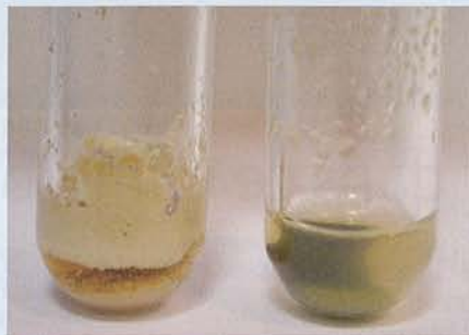
À gauche, une réaction faite en présence du surfactant TPGS. À droite, la même réaction en absence de surfactant.
